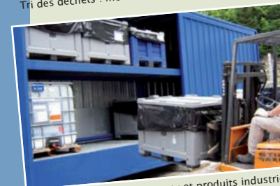
Gestion des déchets dangereux et produits industriels : bacs de rétention, identification...
