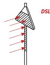
• **DSL** : essai permettant de simuler l'effet de la projection non uniforme de la neige sur l'ensemble du panneau et de son support (sur une hauteur de 2m à 2,5 m au dessus du sol).
