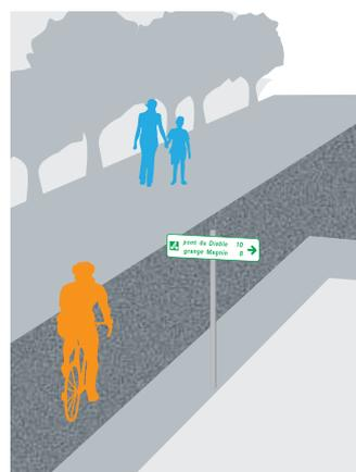
**Avantages** : le panneau de présignalisation (de type Dv40), implanté sur le site propre 10 ou 15m avant le croisement, n'est visible que par les cyclistes circulant sur le site propre. Il permet sans ambiguïté de donner toutes les informations nécessaires avant le carrefour.
