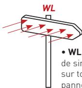
• **WL** : essai permettant de simuler l'effet du vent sur toute la surface du panneau.
